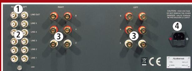
Vue arrière. 1 – Sortie modulation magnétophone. 2 – Cinq entrées ligne asymétriques Cinch 400 mV/10 kOhms. 3 – Double triple borniers de sortie haut-parleurs avec deux possibilités de charge d'impédance 4/8 Ohms. Autorise facilement par son dédoublement le bicâblage, accepte les fiches bananes ou, par serrage, l'âme de câbles de haute définition. 4 – Prise secteur avec phase repérée.
